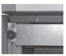
Fig. 87 Adjusting the door safety switch PuroWIN PWPE 75–100
